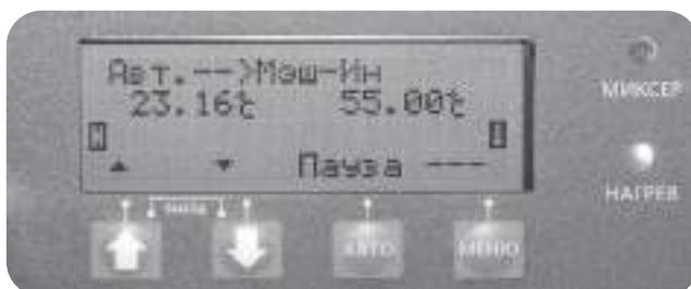
46. Когда температура достигнет 550С, отобразится сообщение: «Темп. Достигнута», нажимаем 3 кнопку («Да»), подтверждая готовность перейти к следующему шагу.
